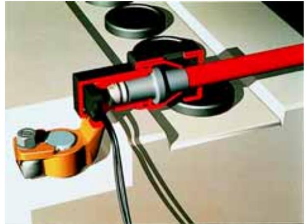
Die Sicherheitsbatterieklammer ist am Pluspol der Batterie verbaut.
