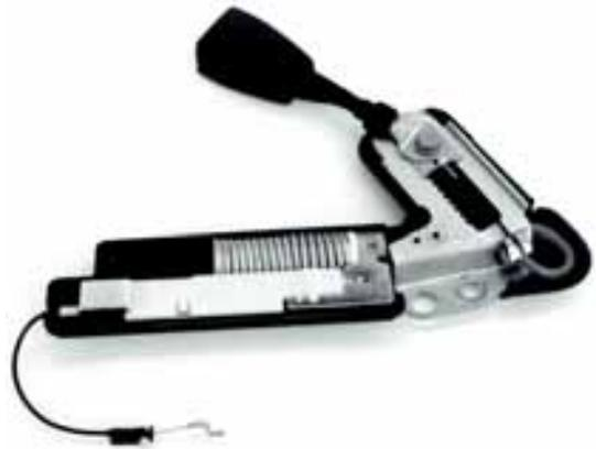
Beim mechanischen Gurtstrammer erkennt ein mechanischer Sensor den Aufprall und löst über einen Schaltmechanismus die Freisetzung der Strammerenergie aus. Durch ein Kraftübertragungselement wird das Gurtschloss schräg nach unten gezogen und damit das Gurtband am Körper des Insassen gestrammt. Beim anschließenden Aufbau der Gurtkraft blockiert ein Verriegelungssystem das Gurtschloss in jeder Strammposition. Der Insasse ist somit besser mit dem Fahrzeug verbunden.
