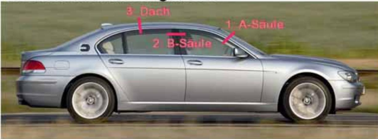
Die A- und B-Säule im Bereich (1) und (2) trennen, anschließend das Dach im Bereich (3) vor der Dachabblaseklappe ca. 20 cm tief einschneiden. Danach kann das Dach nach hinten geklappt und gesichert werden.
