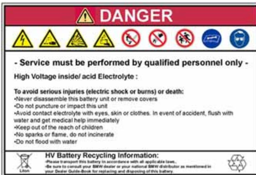
Kennzeichnung der restlichen Hochvoltbauteile:
