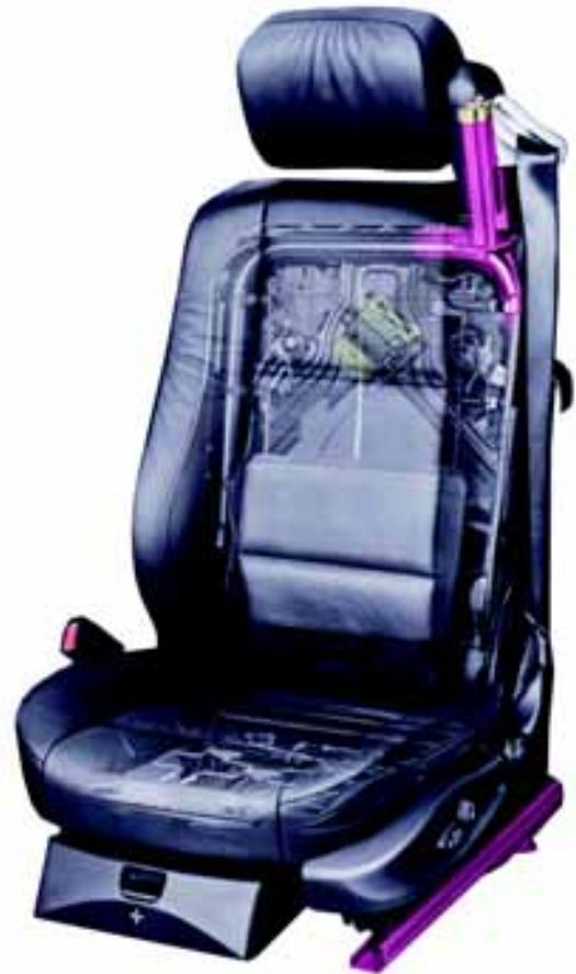
Beim sitzintegrierten Gurtsystem SGS sind sämtliche Gurtelemente einschließlich der Umlenkpunkte in die Sitze verlagert. Bei einem Aufprall werden bei Fahrzeugen ohne B-Säule alle Kräfte in die Bodengruppe eingeleitet.
