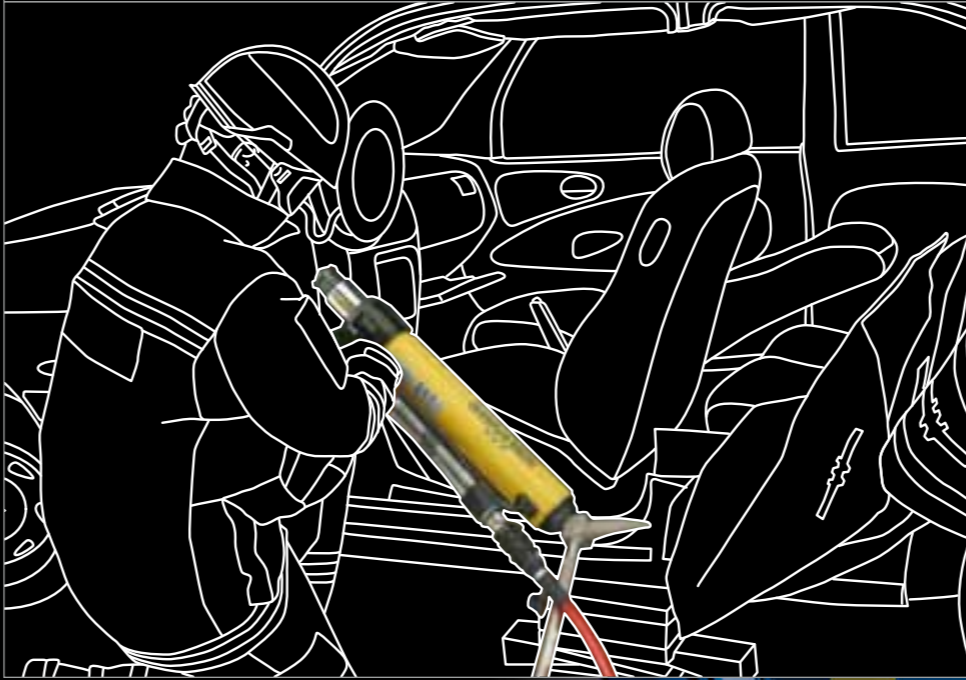
2 Halligan-Tool ansetzen und Rettungszyylinder einsetzen Apply halligan tool and rescue ram
