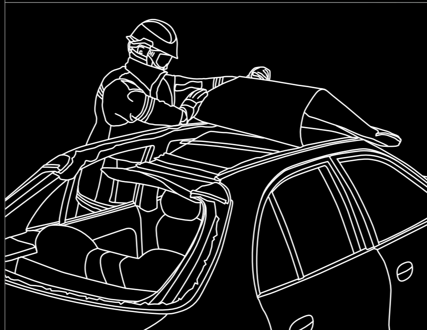
5 Dach nach vorne wegklappen Roof can then be folded forward
